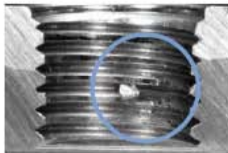
スパッタ付着 (ゲージ GP:NG) Spatter adhesion (Gage GP:NG)
